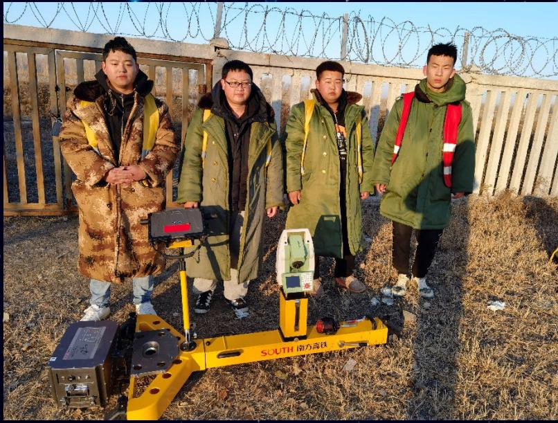
长春至白城铁路全长328公里，是长（春）白（城）乌（兰浩特）快速铁路的重要组成部分，于2017年8月8日正式开通运营，现行时速160公里，提速工程完工后，运行在长春至白城铁路上的动车组列车，将由现在的时速160公里提升至200公里，长白铁路0KM至133KM的线路范围，应用南方测绘惯导小车进行轨道网精测，惯导小车应用单点设站功能，作业效率高，精度高，圆满完成了在既有线特点要求的线路精测项目得到了业主的一致认可，在铁路线路V型天窗运行情况下，使用单点测量模式，一个天窗期内可以测量4KM以上的轨道数据，大大提高了测量速度，最大可能保证铁路线路的正常运行。
