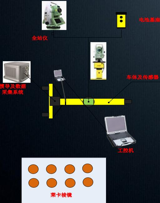
全测小车主要由惯导及数据采集系统、全站仪、工控机、GNSS天线、电池基座、车体、棱镜、电源数据线、控制主板和各种精密传感器组成。
